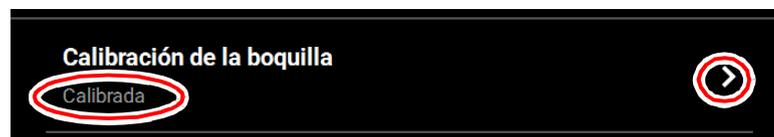
La página de *calibración de la boquilla* tiene una opción para realizar una calibración automática de la boquilla y, además, una calibración manual de la boquilla. Al presionar el botón **Iniciar** asociado con cualquiera de estas opciones podrá realizar ese procedimiento de calibración particular. Cada procedimiento de calibración se proporciona en forma de un asistente que lo guiará en el proceso de realizar el procedimiento de calibración.
