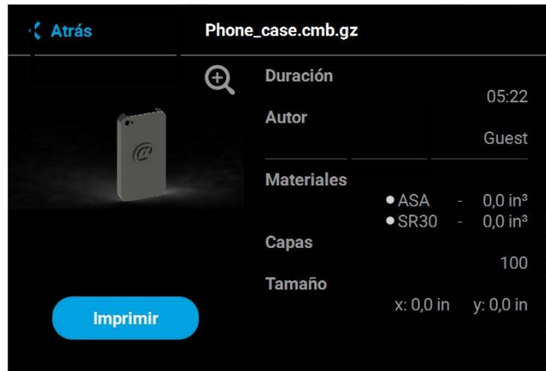
La parte izquierda de la página de detalles del trabajo muestra una representación visual de cómo se verá la pieza una vez que se complete la construcción.
