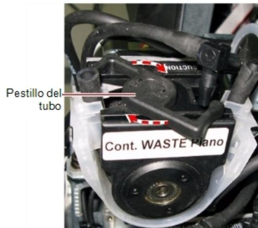
Figura 6-135 Soltando el pestillo del tubo
