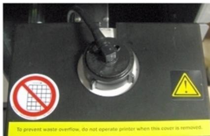
Figura 6-143 Tapa instalada sobre el recipiente para residuos
