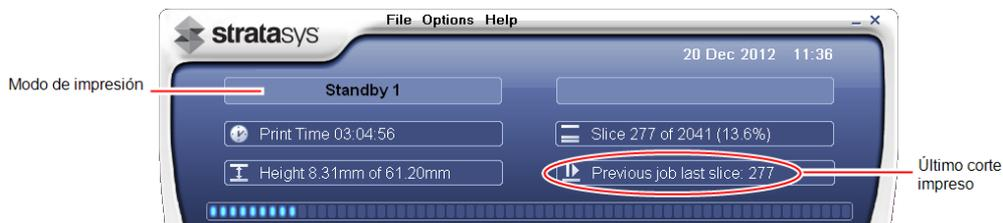
Figura 6-12 Interfaz de la impresora después de la interrupción de la impresión
