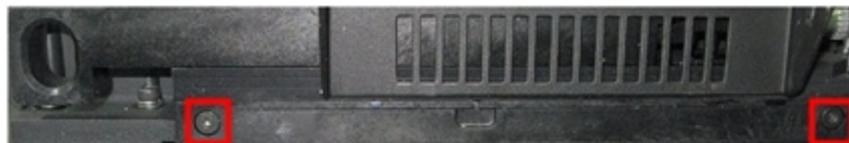
Figura 6-54 Tornillos del colector de residuos del rodillo
