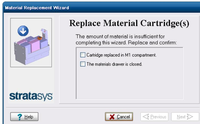
Figura 6-22 Se le solicita reemplazar el cartucho debido a cantidad insuficiente de material
