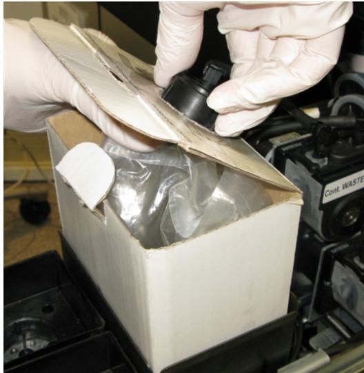
Figura 6-126 Sujeción del tubo de drenaje de residuos
