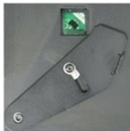
Figura 6-92 Sensor UV expuesto
