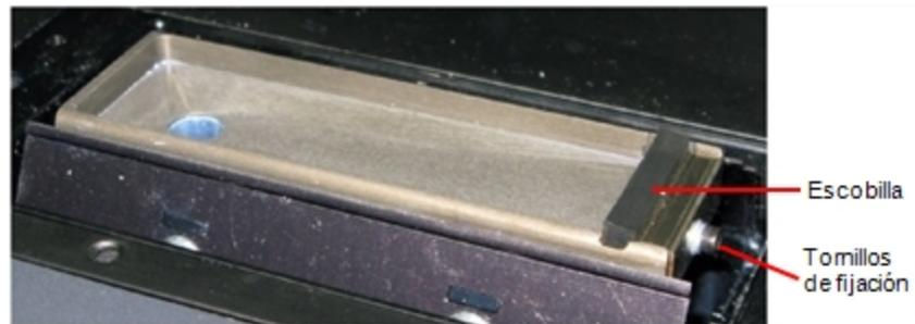
Figura 6-44 Escobilla y drenaje de material en exceso
