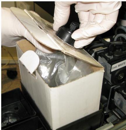
Figura 6-142 Recipiente de residuos con tubo de residuos colocado
