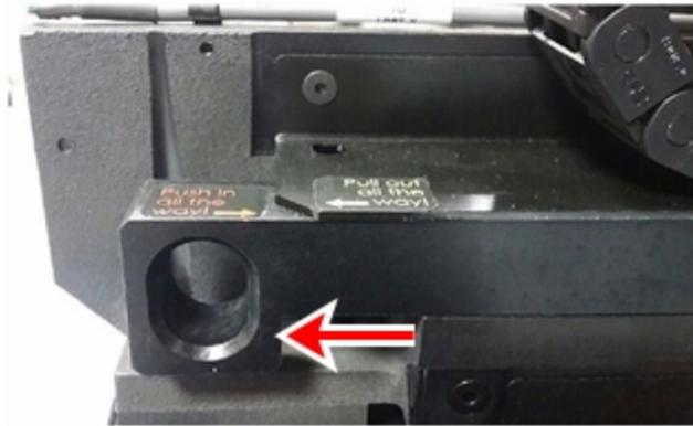
Figura 6-53 Liberación de los tubos de drenaje del colector de residuos
