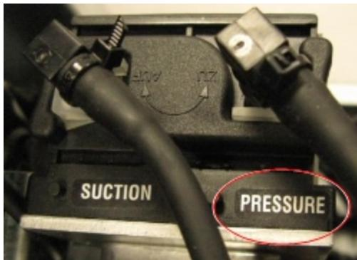
Figura 6-132 Tubos conectados a la bomba de residuos
