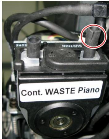
Figura 6-134 Tubos desconectados de la bomba de residuos
