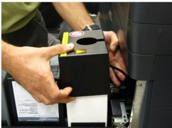
Figura 6-148 Extracción de la tapa del recipiente para residuos.
