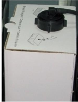
Figura 6-149 Recipiente de residuos con tubo de drenaje colocado
