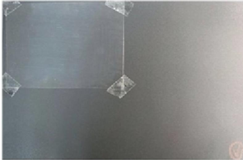
Figura 6-59 Ubicación de la transparencia en la bandeja de construcción
