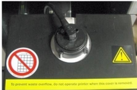
Figura 6-150 Tapa instalada sobre el recipiente para residuos
