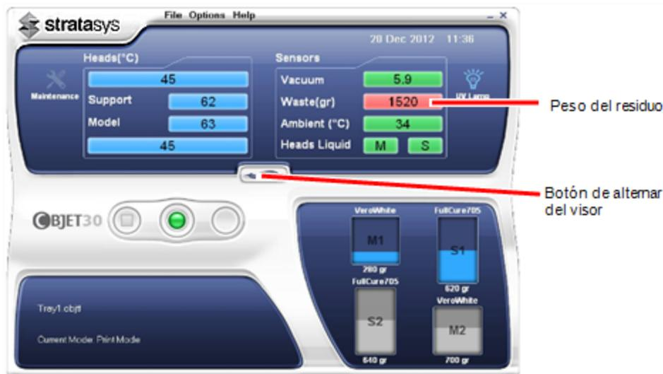
Figura 6-147 Interfaz de la impresora, muestra el peso del residuo (el fondo rojo indica alerta para el operador)
