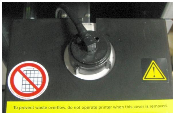
Figura 6-127 Tapa instalada sobre el recipiente para residuos
